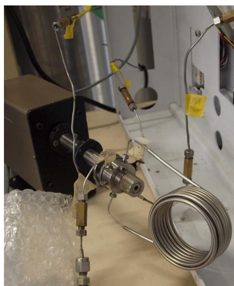
(d) Current sample loop – 10cc
